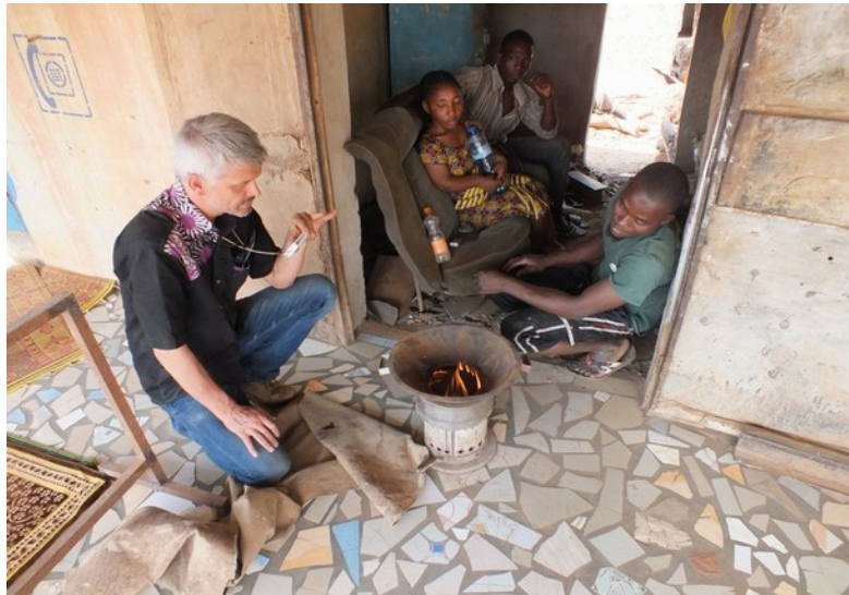
Burkina Faso: Pyrokocher aus Abfallmetall - spart Materialkosten ist aber arbeitsaufwändiger und wäre übertragbar auf Madagaskar
